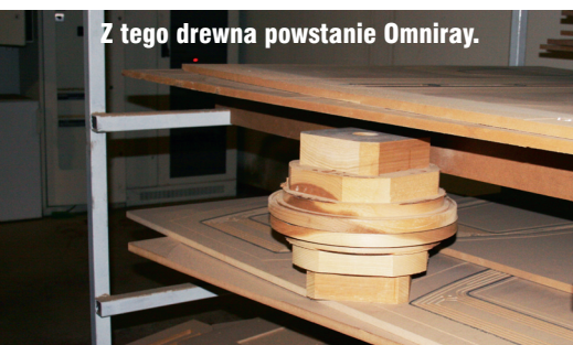
Wstępnie przycięte elementy obudów.
