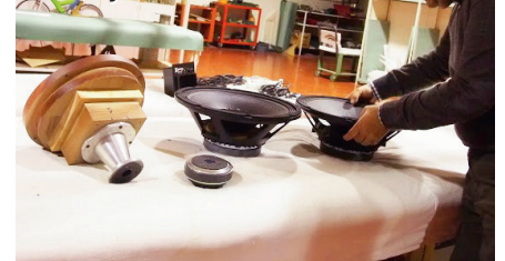
Omniray z elementami drivera kompresyjnego, obok dwa celulozowe woofery B&C.
